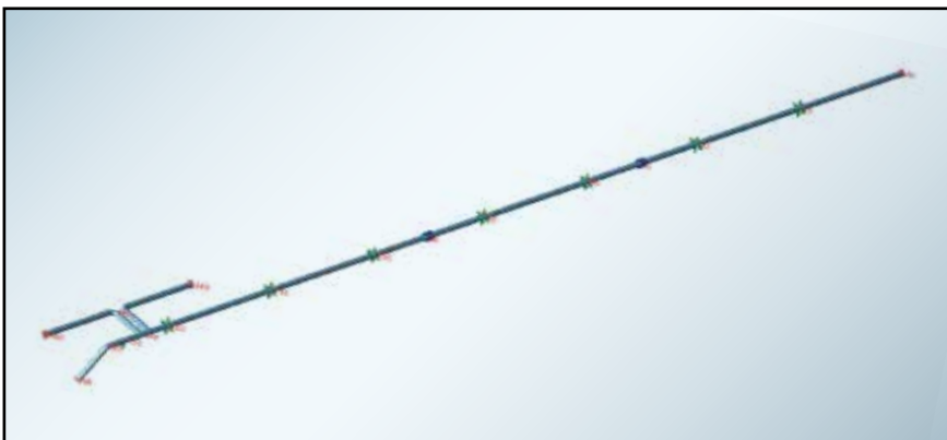
Рис. 2. Модель трубопроводной системы, выполненная в CAESAR II
