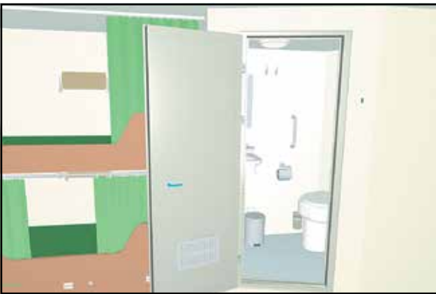
Рис. 3. Назначение динамических и кинематических свойств. В примере показана реализация открывания двери при входе в санузел с контролем угла открытия
