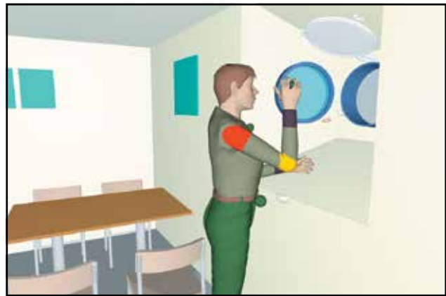
Рис. 5. Учет антропологических особенностей. Пример демонстрирует контроль удобства выполнения операций персоналом. Цветовая подсветка суставов отражает уровень удобства выполнения операции
