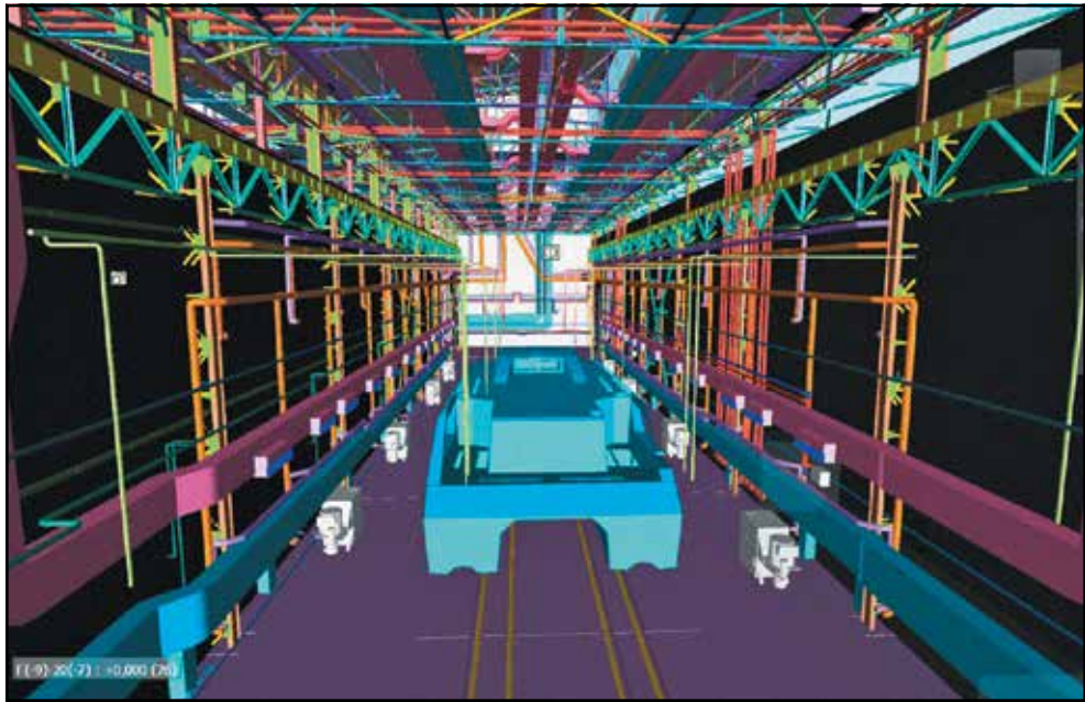
Рис. 4. Модель корабля, импортированная BIM-моделью цеха
