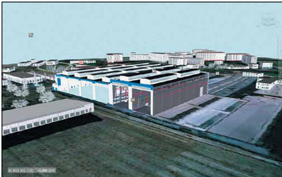
Рис. 2. BIM-модель цеха на “электронной подложке” – генплане, созданном с использованием ГИС
