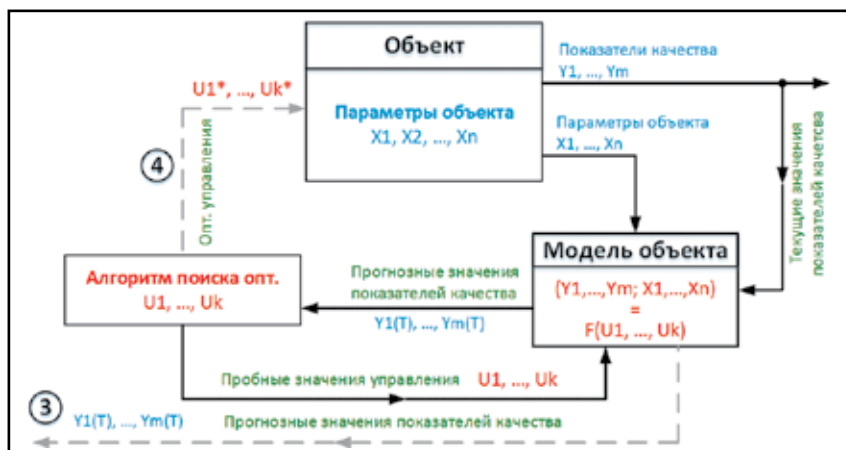
Рис. 7. Схема прогнозирования (3) и управления (4) по модели объекта
