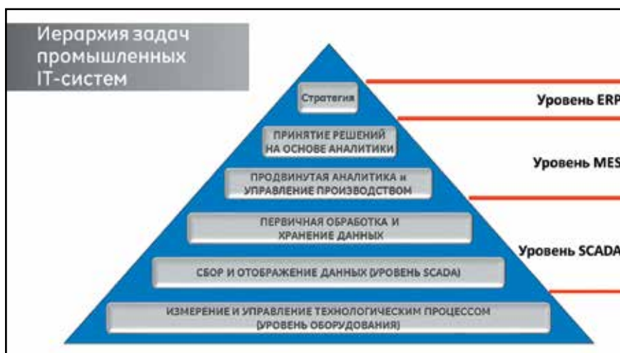
Рис. 1. Иерархия задач производственных ИУС
