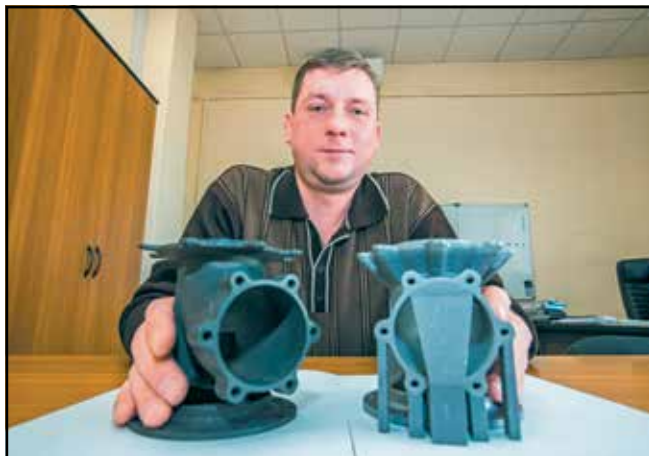
Детали топливной системы, изготовленные с помощью технологии стереолитографии
