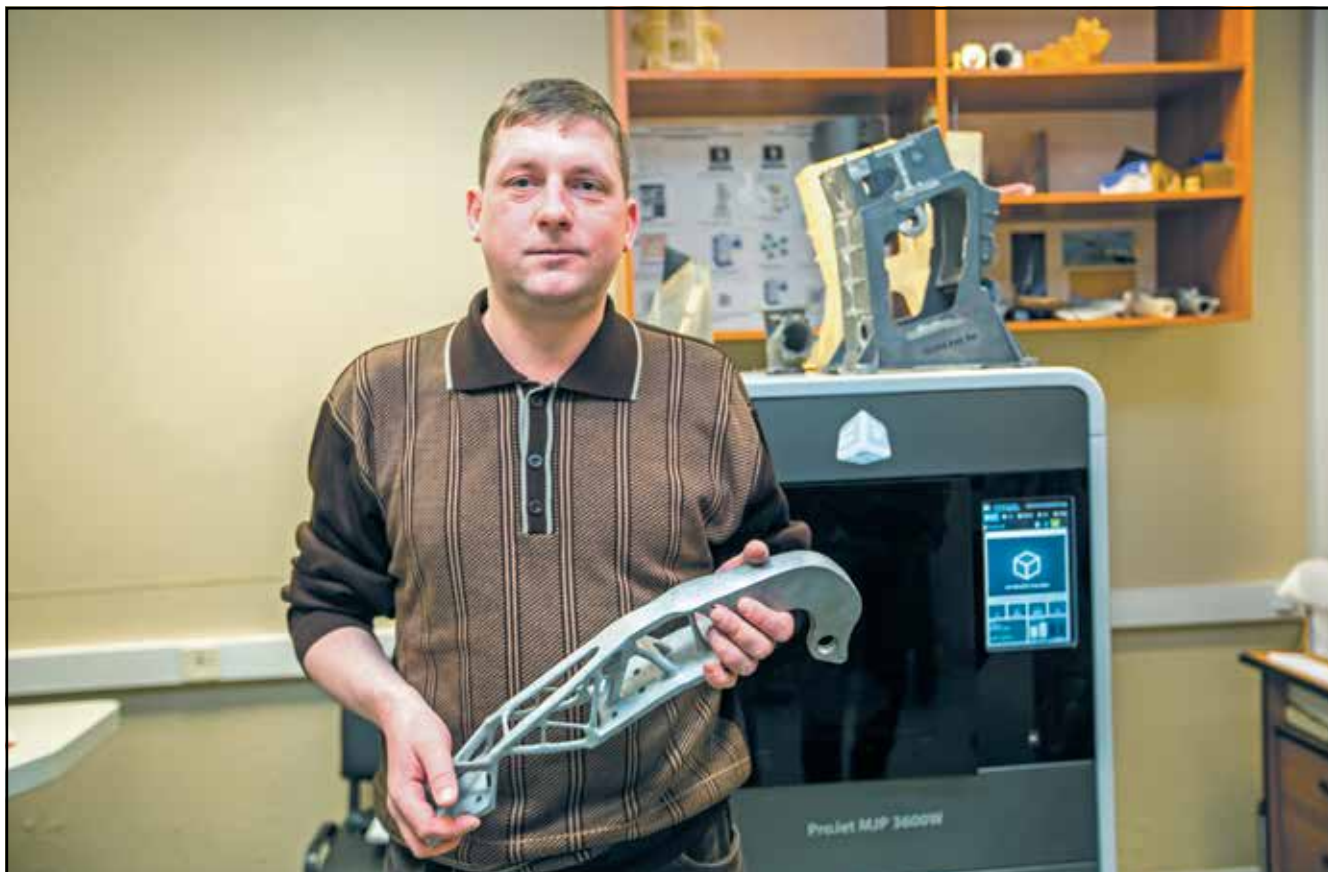
Ведущий технолог отдела материаловедения Антон Леонов демонстрирует алюминиевый силовой кронштейн для нового истребителя
