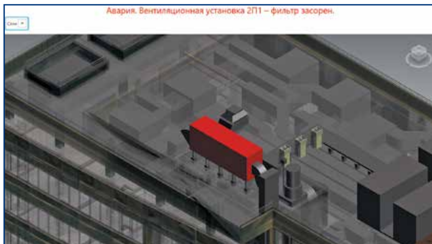
Рис. 5. Пример отображения аварии по засорению фильтра в приложении “Smart эксплуатация”
