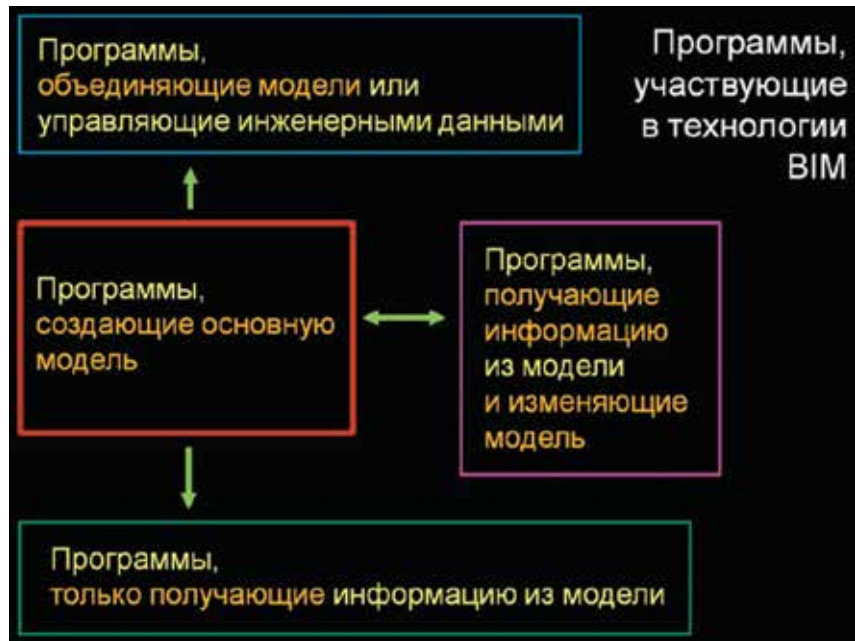
Рис. 2. Структура взаимосвязей базовых программ, участвующих в технологии BIM (каждая стрелочка – это VR-интерфейс)
