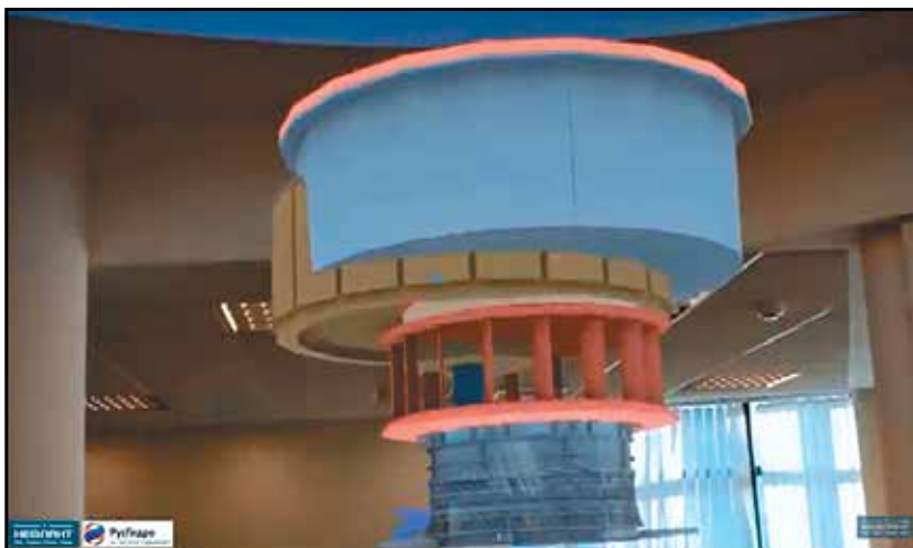
Рис. 7. Применение технологий дополненной реальности Microsoft HoloLens для планирования процесса демонтажа гидроагрегата Волжской ГЭС, спроектированной АО “Институт Гидропроект” (ПАО “РусГидро”)
