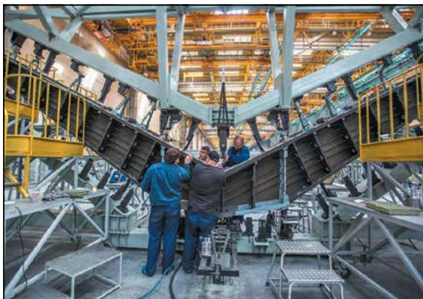
Скоро разделку отверстий при сборке кия стабилизатора МС-21 на “Авиастар-СП” возьмет на себя робот
