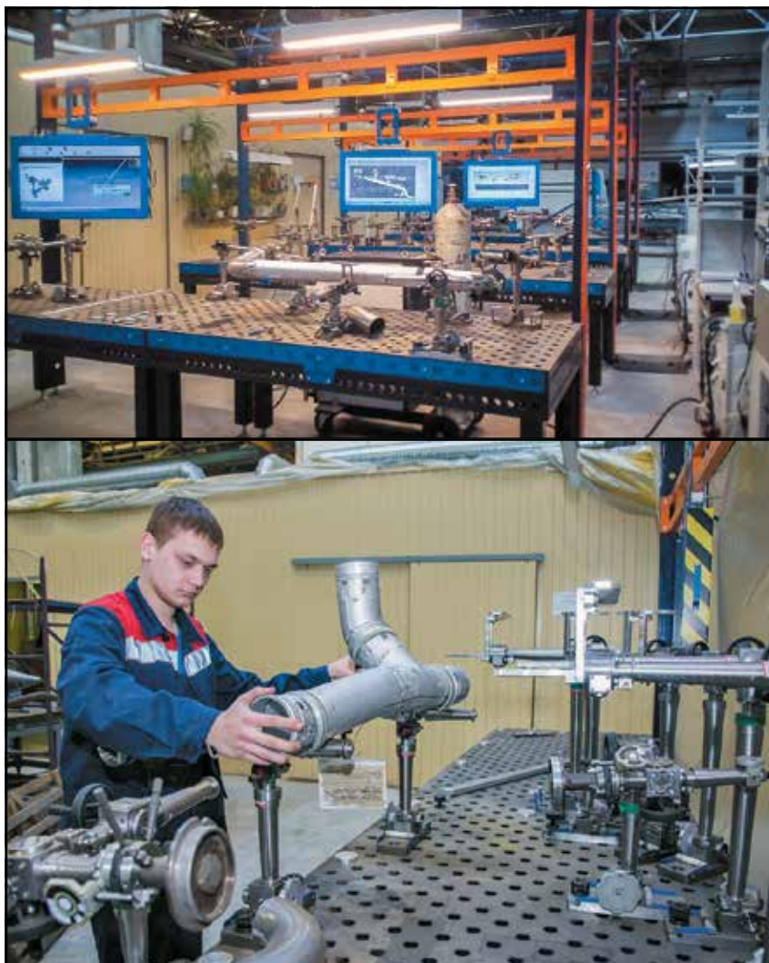
Стапель для сборки трубопроводов УСП-21 на заводе «Авиастар-СП» позволяет вести сборку трубопроводов по электронным цифровым моделям
