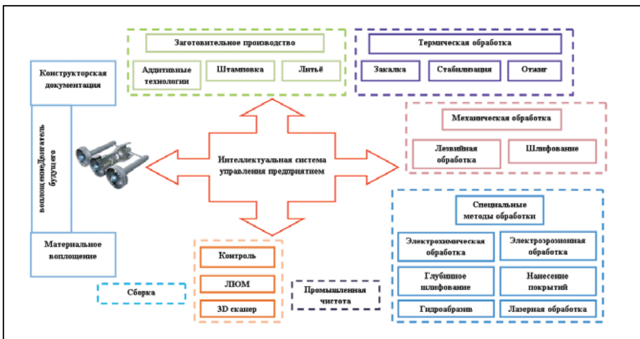
Рис. 1. Схема унифицированного технологического процесса “Умной фабрики”
