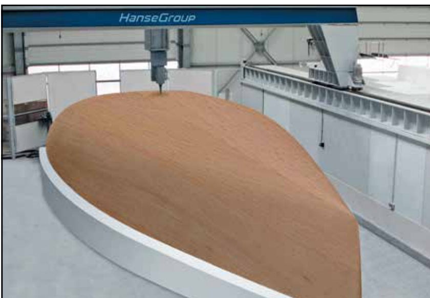
Рис. 3. Проект HanseYachts AG позволит изготавливать корпус судна на 3D-принтере
