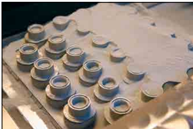
Завихрители фронтального устройства камеры сгорания перспективного авиационного двигателя ПД-14
