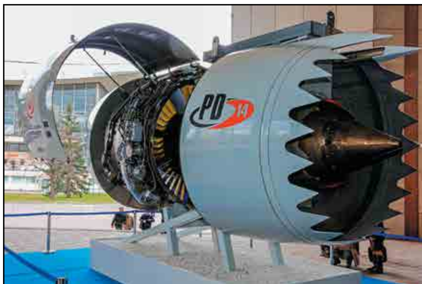
Турбовентиляторный двухконтурный двигатель ПД-14
