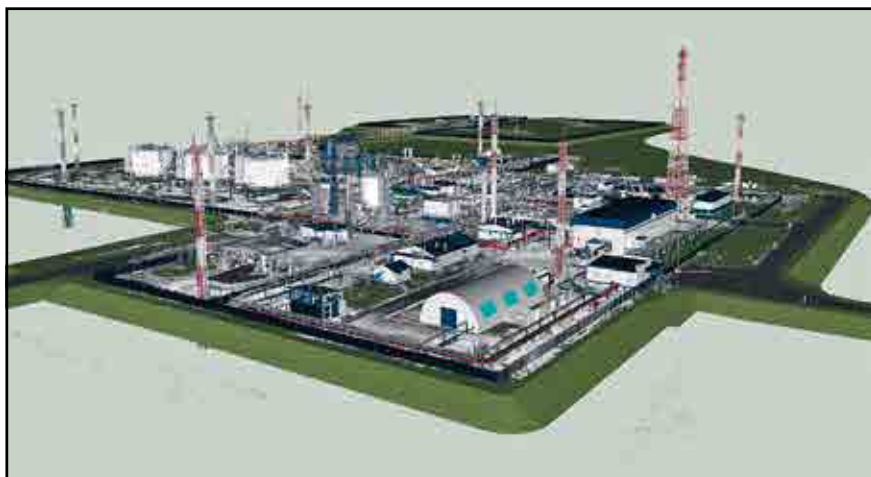
Рис. 5. Наложение облака точек ЦПС лазерного сканирования на ПРИМ Новопортовского месторождения для оценки соответствия реальному состоянию объекта
