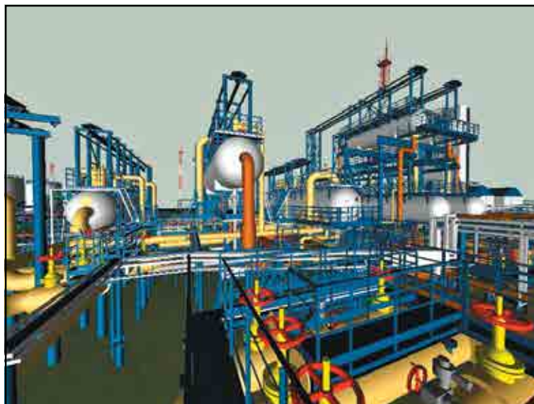
Рис. 3. ИМ ЦПС Новопортовского месторождения. Сепараторы технологической установки
