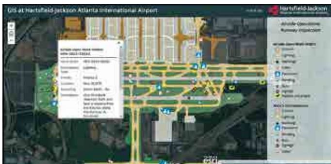
Рис. 2. Отображение проблем, выявленных в результате инспекции летного поля, с их описанием и приоритетом
