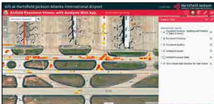
Рис. 3. Отображение дефектов покрытия летного поля с их характеристикой
