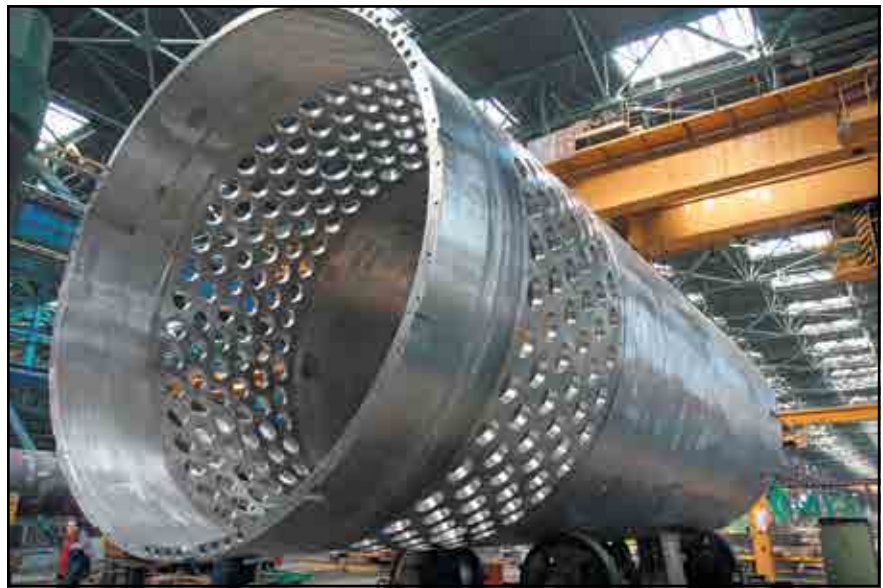
Продукция “Атоммаш”. Шахта внутрикорпусная корпуса ректора
