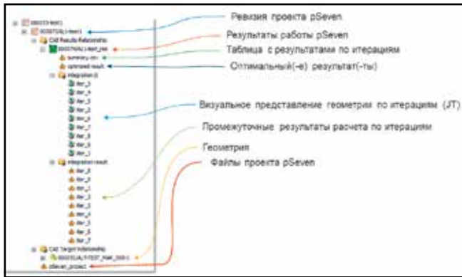
Рис. 6. Графическое представление модели данных оптимизационного расчета в среде Teamcenter
