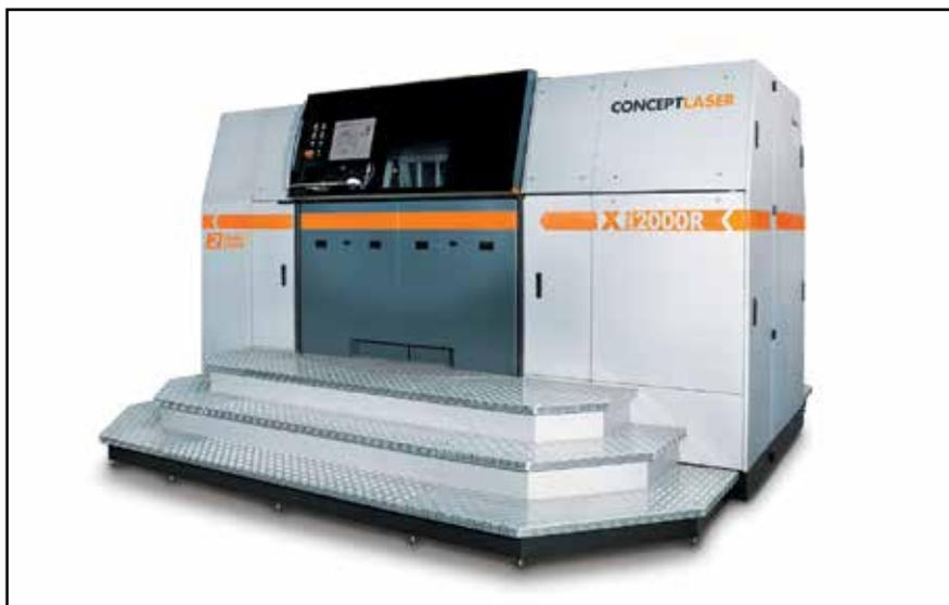
Новый комплекс Concept Laser X line 2000R (область печати 800x400x500 мм) с двумя лазерами мощностью по 1 кВт
