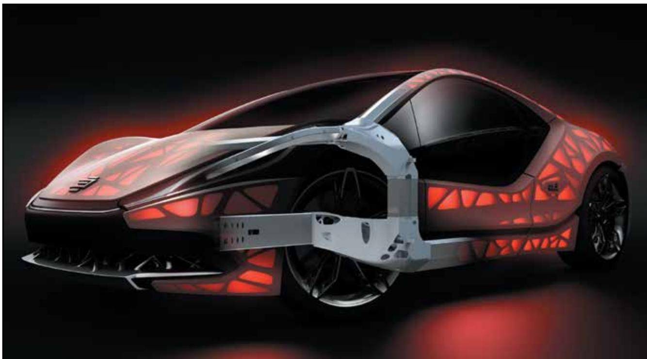
Технологическое решение: каркас кузова NextGen объединил функциональность, малый вес и универсальность; бионическая концептуальная модель, выпущенная по технологиям гибридного аддитивного производства, демонстрирует новый подход к изготовлению кузовов, которые легко адаптировать к различным уровням нагрузок
