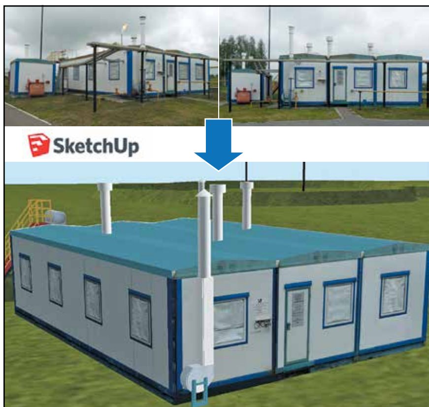
Рис. 1. Трехмерная модель блок-бокса газосепарационной установки
