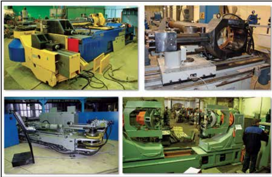
Рис. 5. Трубогибочный парк ОАО "ПО "Севмаш" T-50АБ, T-90АБ и CNC-220 POWER (рис. 5).
