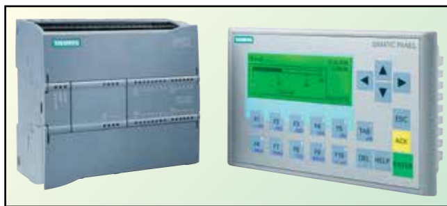
Рис. 3. SIMATIC S7-1200 с панелью управления
