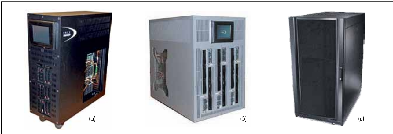
Рис. 3. Ряд АПК разработки ФГУП "РФЯЦ-ВНИИЭФ", основу которых составляют КС-ЭВМ различной производительности: (а) АПК-1М (1 ТФлопс); (б) АПК-3 (3 ТФлопс); (в) АПК-5 (5 ТФлопс)
