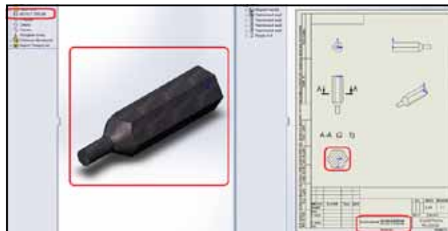
Рис. 4. Материал, назначенный с помощью приложения SWR-Материалы
