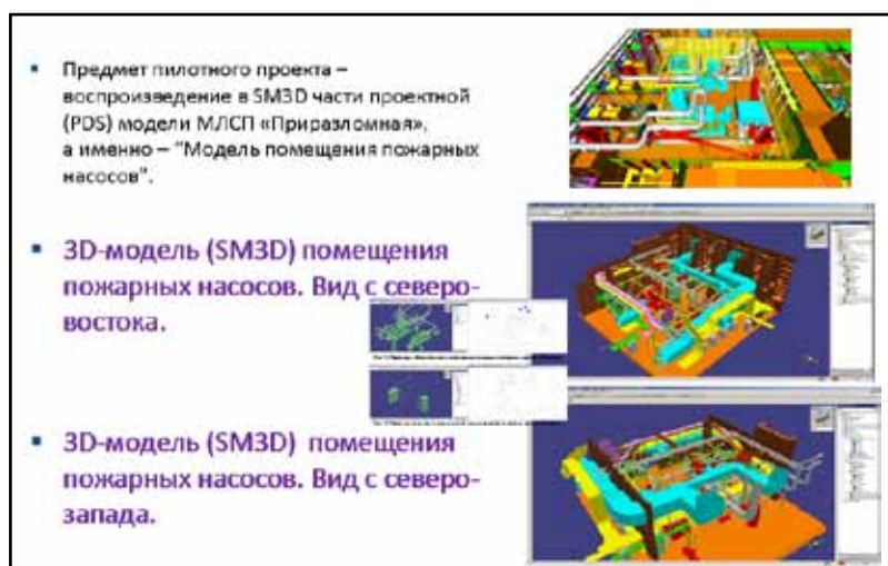
Рис. 8. Пример миграции фрагмента PDS-модели МЛСП "Приразломная" в среду SM3D
