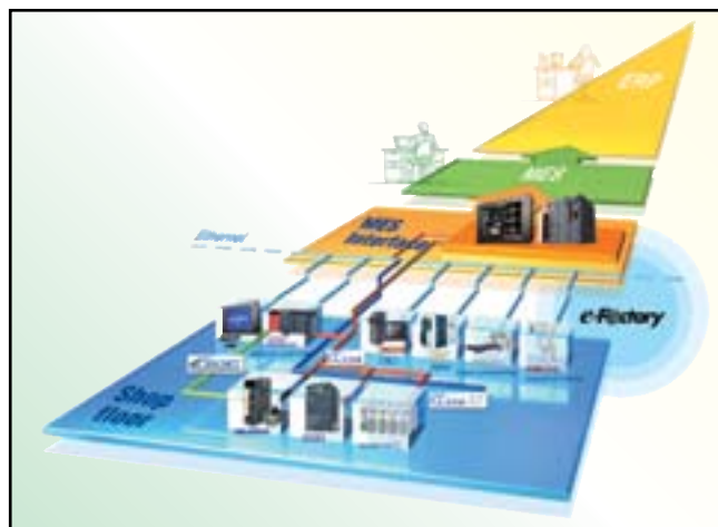
Рис. 1. Концепция e-F@ctory компании Mitsubishi Electric предполагает интеграцию оборудования промышленной автоматизации в информационную систему предприятия
