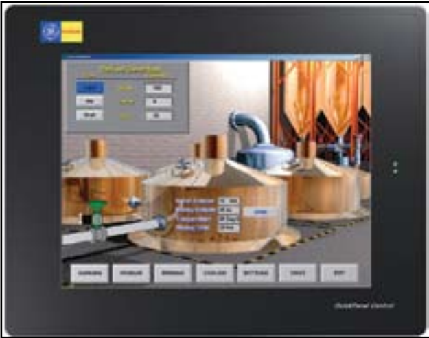
Рис. 5. Устройство визуализации и управления QuickPanel Control новые модели QuickPanel (рис. 5) – Control (ведущее управляющее устройство) и View (пассивная панель отображения информации).
