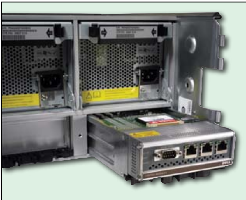
Контроллер с тремя Ethernet-портами в системе PS5500E
