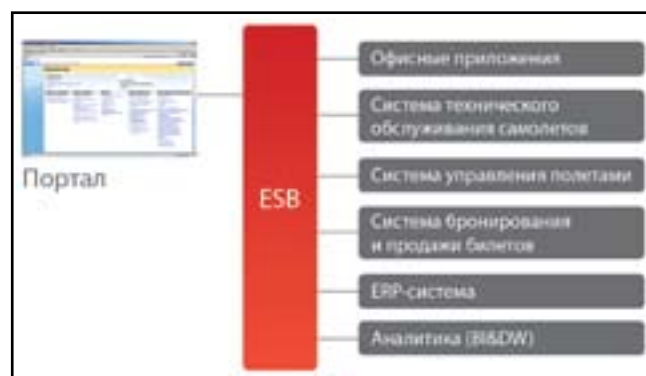
Обобщенная схема КИС авиакомпании в среде SOA
