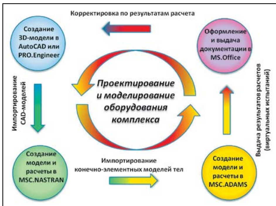
Схема проектирования с использованием моделирования в программных продуктах MSC Software
