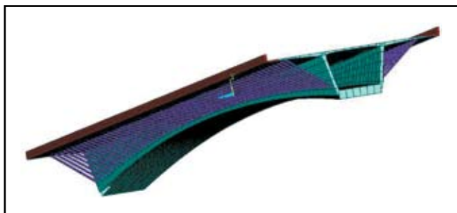
Рис. 4. Предварительно нагруженные тросы на балочных элементах
