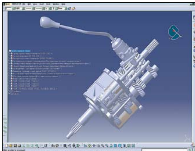
Рис. 1. Подборка коробки передач УАЗ 3162, выполненная в рамках курсового проектирования студентами 4-го курса. Произведен анализ собираемости изделия
