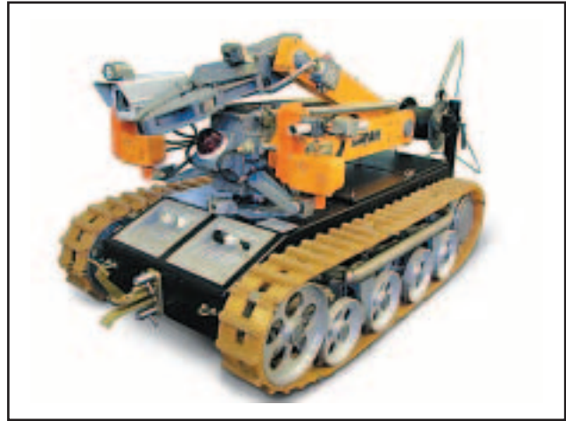
Рис. 8. Готовое изделие – мобильный робот "Варан"
