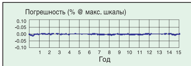
Рис. 3. Реальная погрешность показаний тестовых датчиков в течение 15 лет
