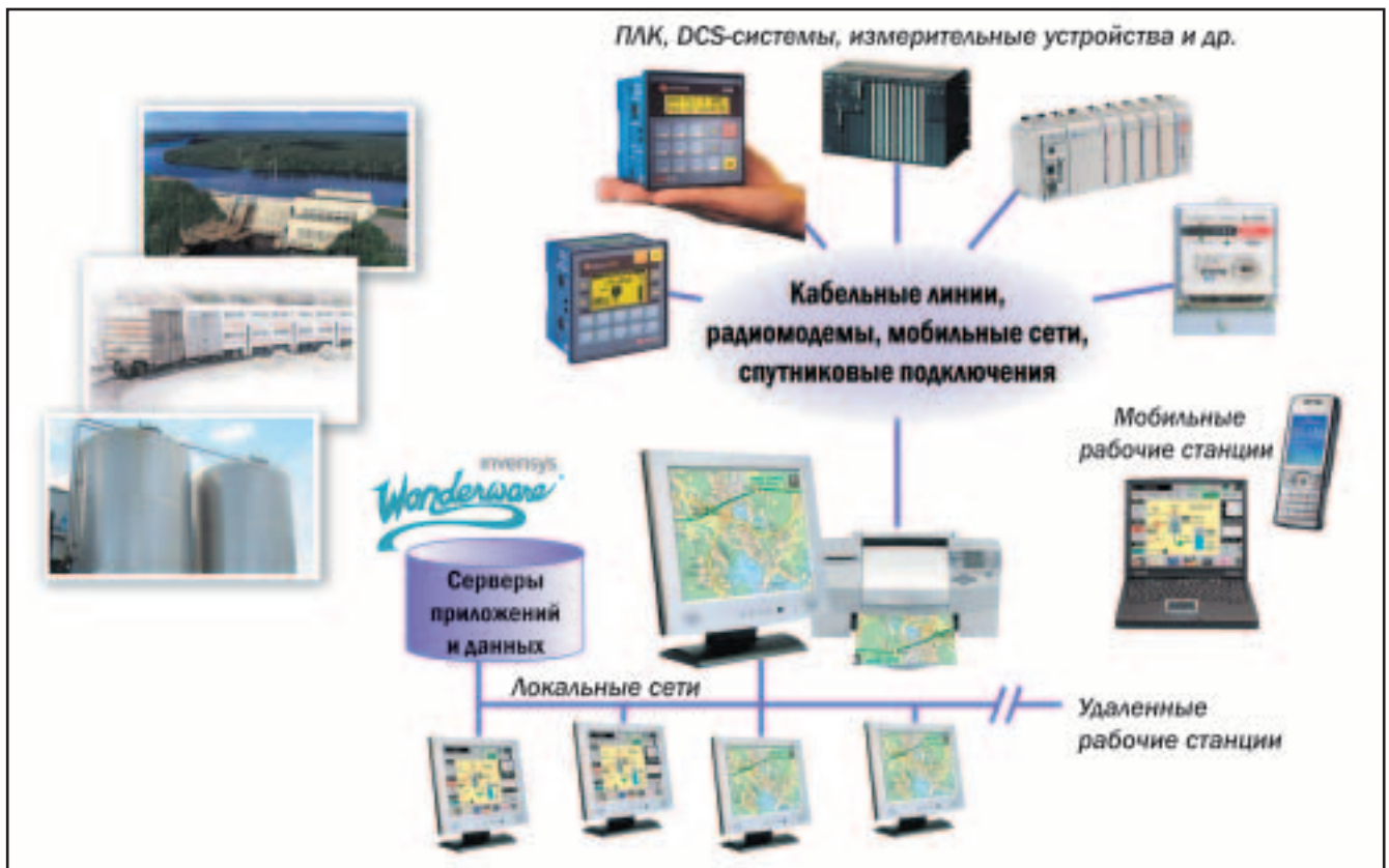
Рис. 2. Архитектура Wonderware Geo-SCADA
