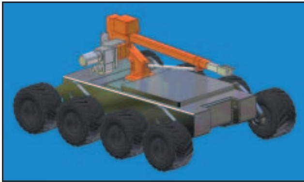
Рис. 2. Транспортное средство мобильного робота с изменяемой геометрией колесного движителя
