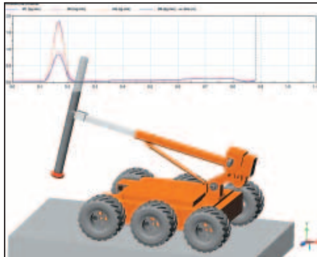
Рис. 7. Моделирование поведения МР при выстреле разрушителя ВУ
