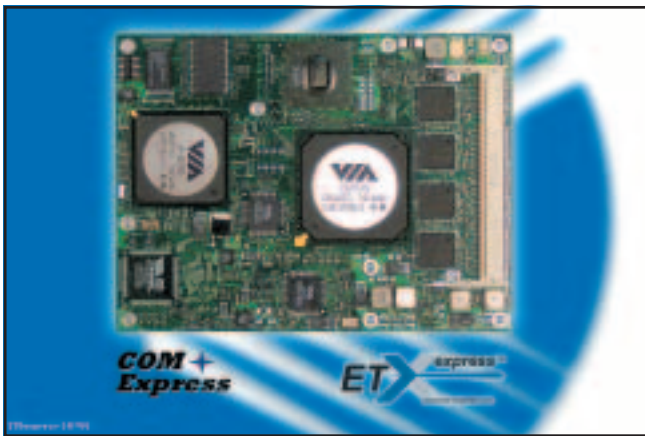
Рис. 4. Модуль ETХexpress-CN8, выполненный на базе ЦП VIA C7
