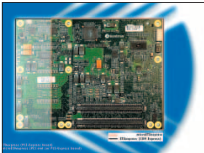
Рис. 2. Габариты конструктивов COM Express и Compact COM Express
