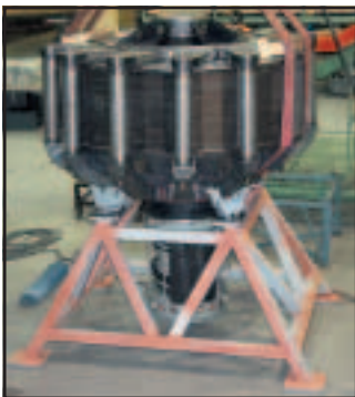
Газотурбинный двигатель ГТД-1С для тепловоза – изделие и трехмерная модель
