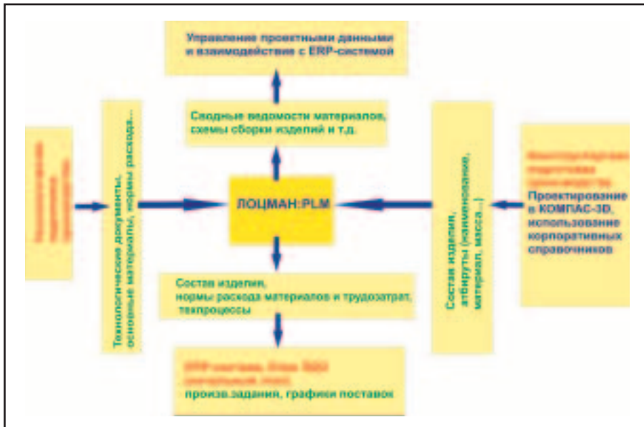
Схема системы управления инженерными данными НПП "Проект-техника", распространенная на холдинг в целом
