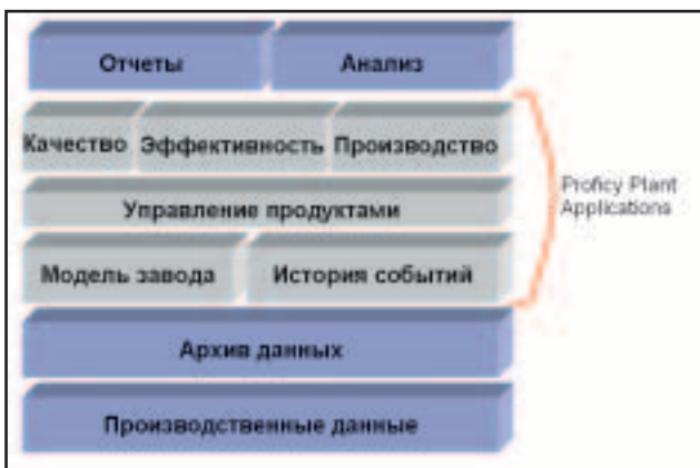
Рис. 3. Структура MES-системы и состав компонентов Proficy Plant Applications
