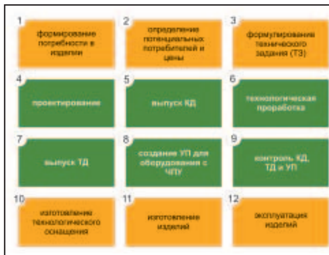
Рис. 1. Область применения интегрированных CAD/CAM/CAPP-систем в жизненном цикле изделия (блоки зеленого цвета)
